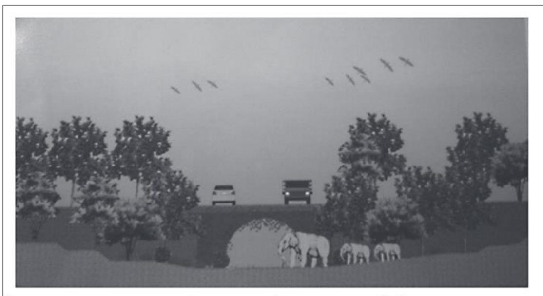
รูปที่ 3-8 ตัวอย่างการออกแบบทางเชื่อมระบบนิเวศเพื่อลดผลกระทบของพื้นที่ป่าอุทยานแห่งชาติไทรโยคและอุทยานแห่งชาติเอราวัณที่แยกขาดออกจากกันโดยถนน
